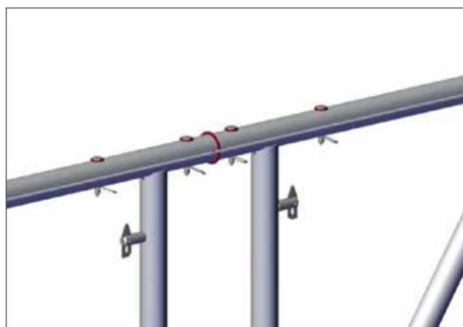
Ora anche il secondo traliccio del tetto di emergenza o il supporto per colmo vengono collegati con il tubo a inserimento tramite bulloni, spinotti e guarnizioni in gomma spugnosa e quindi fissati.
