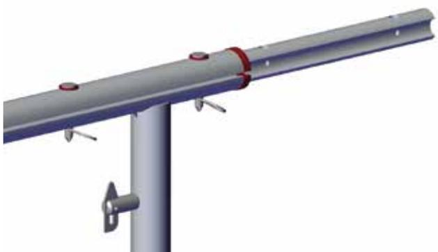
In seguito i bulloni vengono fissati con lo spinotto. Anche il tubo a inserimento nel corrente inferiore viene fissato tramite bulloni e spinotti.
