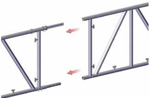
Quando i due tubi a inserimento sono fissati, viene introdotto il secondo traliccio del tetto di emergenza o il supporto per colmo.
