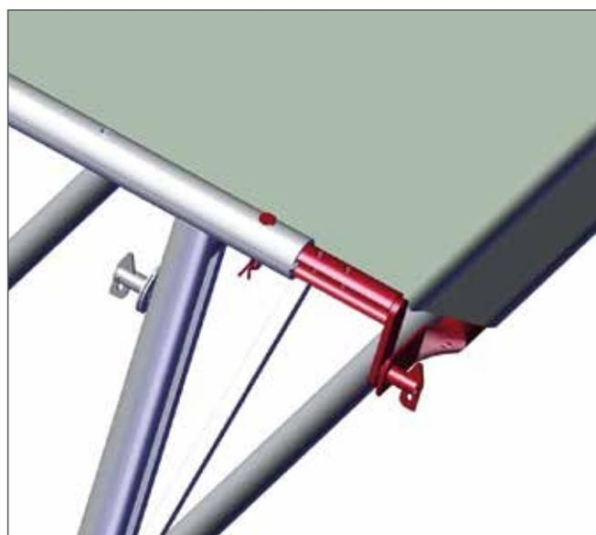
Il telone viene teso con l'ausilio dell'elemento di serraggio. L'elemento di serraggio per teli viene fissato nella posizione desiderata sul corrente superiore tramite bulloni e copiglie a molla.
